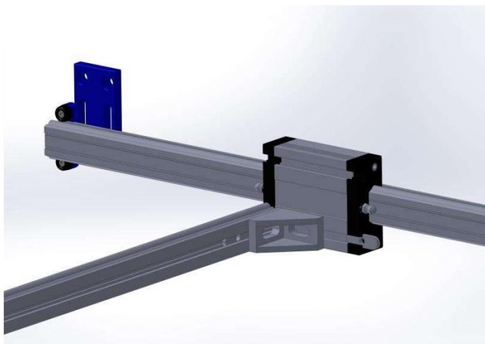
Posizionare la barra orizzontale come in figura tenendo la squadretta parallela al carrello, inserire i dadi filettati e fissare entrambi i lati.
