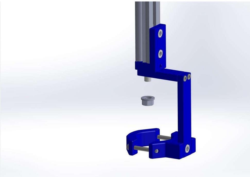
Per fissare il supporto universale sull' asta in carbonio, avvitare la vite M8 x 20 sulla boccia dell'asta e fissare i grani M4 per impedirne la svitatura.
